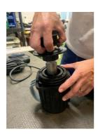
4. Setzen Sie alle Teile wieder zusammen und achten Sie beim Zusammenschrauben darauf, dass alle Bauteile, inklusive Dichtungsring an Ihrem Platz sind.
