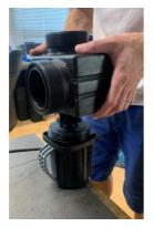
5. Setzen Sie den Pumpenkopf gerade an und schieben Sie ihn gerade und langsam über den Impeller bis Sie einen Widerstand spüren. Dann drücken Sie den Pumpenkopf mit etwas Kraft vollends runter.
